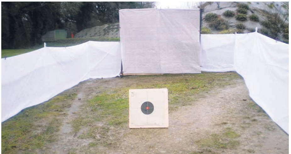
Installation de la bâche arrière sur le portique des bâches latérales qui sont écartées d'une distance de 4,60 m. La cible est positionnée à 5 m devant la bâche arrière.
