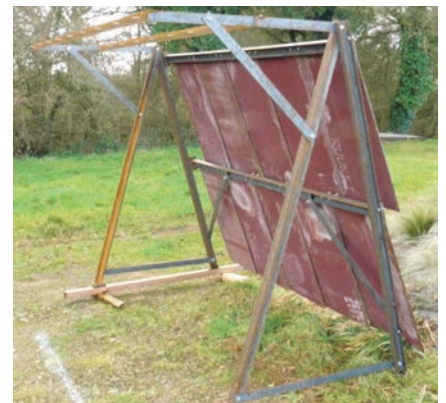
Construction et installation du portique en acier de blindage de 6mm d'une longueur de 2,60 m et de 2 m de haut, sur un sol naturel de type « chemin forestier ».
