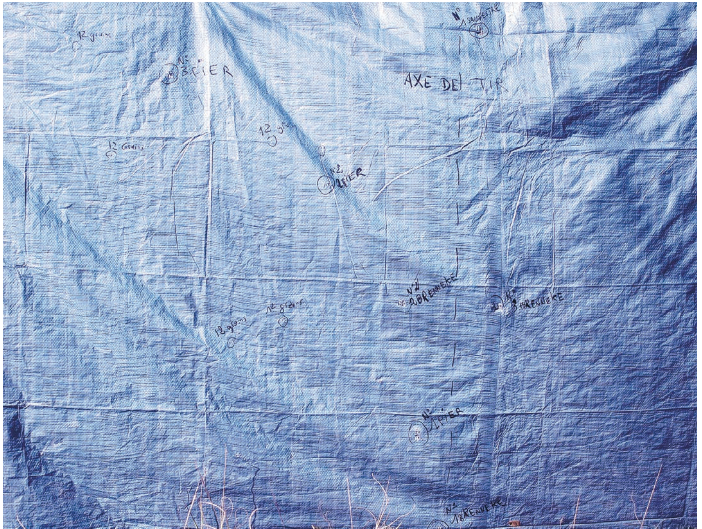
L'écran est examiné après chaque tir qui est repéré au marqueur permanent (BRENNEKE, SAUVESTRE, F.I.E.R, 8x68S, chevrotines) Le sol est sommairement régalé après chaque impact
