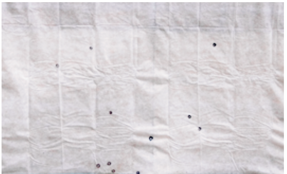
Test de tir n°1 impacts arrières; 12 grains ont ricoché vers la bâche arrière. Leurs hauteurs respectives sont d'1,71 m, 0,93 m, 0,85 m; 0,50 m, 0,34 m, 0,18 m, 0,16 m. L'angle de ricochet du grain arrivé le plus haut est de 19°.
